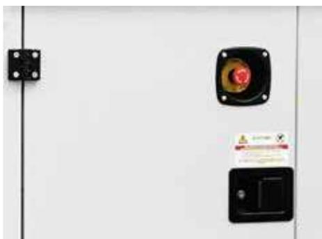
**FUNGO DI EMERGENZA:** pulsante a fungo rosso con targhetta gialla. Dovrà essere azionato solo con lo scopo di mettere in sicurezza il sistema e le persone che ne operano, cioè nel caso in cui l'operatore avverta un pericolo derivante dalla macchina. L'attivazione del pulsante di emergenza durante il normale funzionamento della macchina, ne provoca l'arresto immediato. Tale pulsante agisce su una centralina di sicurezza che intercetta elettricamente tutte le utenze della macchina.
